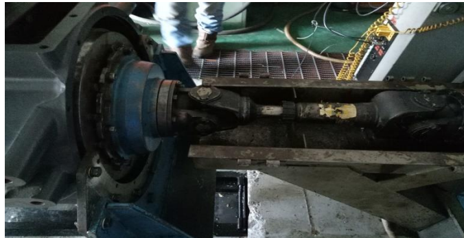
Gambar 3.6 Menyambungkan engine dengan dynamometer.
